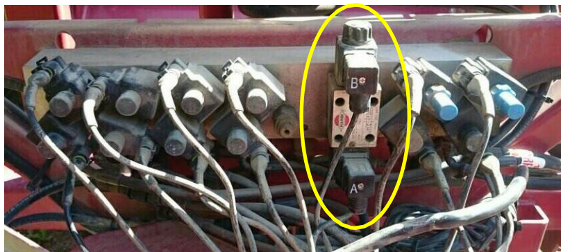
Figur B, Ventilblok med flowretningsventil markeret
