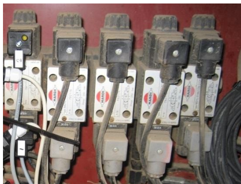
Figur A, Typisk ventilblok med retningsventiler
