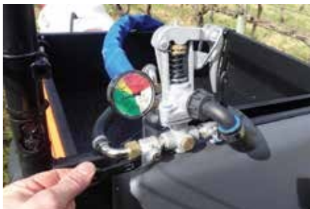
Figur 25a: Drej venstre og højre haner individuelt for at teste sprøjtemønsteret.
