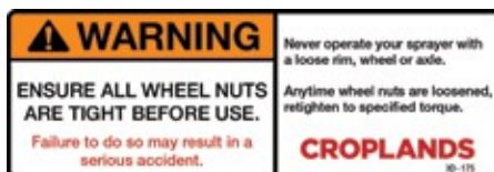
Figur 8: Kontroller regelmæssigt, at hjulmøtrikkerne er stramme
