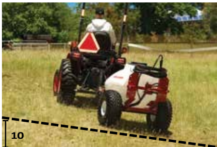
Den maksimale anbefalede hældning for sikker brug er 10 grader.
