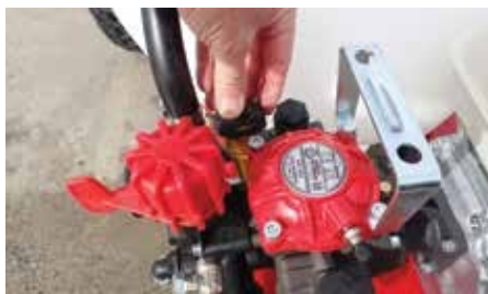
Figur 11: Kontroller pumpens olie niveau.
