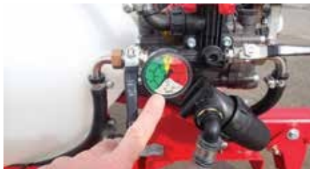
Figur 19: 10 bar maksimalt tryk for drift af RL10.
