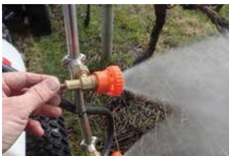
Sprøjtemønsteret til vinranker skal justeres for at opnå en god sprøjtedækning.
