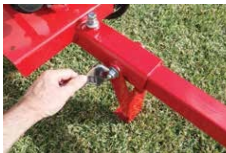
Figur 3: Løsn stativet og juster længden. Gentag trin 2 og 3, når længden er fastlagt.
