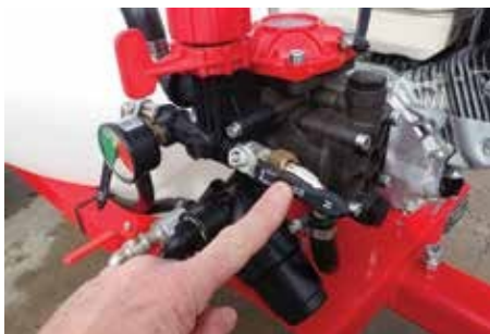
Figur 20: Drej ventilen på rullen.
