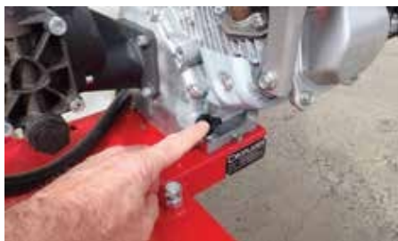
Figur 10: Kontrol af oliestand.
