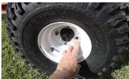
Figur 8: Kontroller regelmæssigt, at hjulmøtrikkerne er stramme
