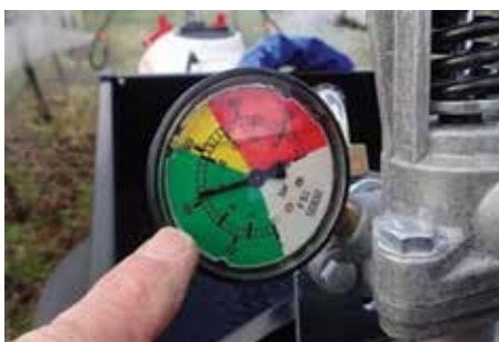
Figur 26: Det anbefales ikke at overskride et sprøjtetryk på 30 bar.
