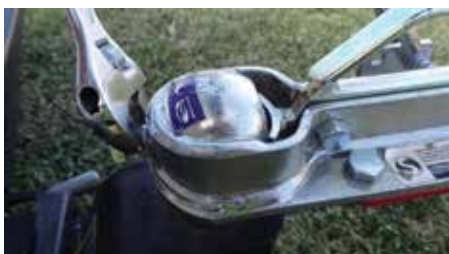
Figur 4c: Sørg for, at låsemøtrikken er strammet, når justeringen er færdig.
