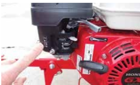
Figur 13: Choke- og brændstof til/fra-kontakter.
