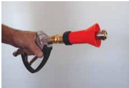
Figur 23: Træk det orange kegleformede dæksel tilbage for normal sprøjtning
