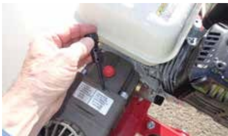
Figur 12a: Sæt målepinden i AR303- eller AR30-pumpegearkassen ved at fjerne den røde prop.
