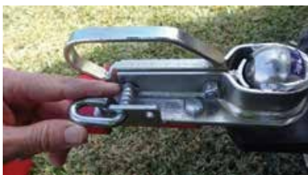
Figur 4b: Sørg for, at stiften kan fastgøres.
