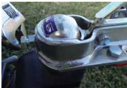
Figur 4: Juster koblingen, så den passer, ved at justere bolten som vist ovenfor. Spænd tilstrækkeligt, så koblingen ikke kan springe af trækbolten, når håndtaget er fastgjort.
