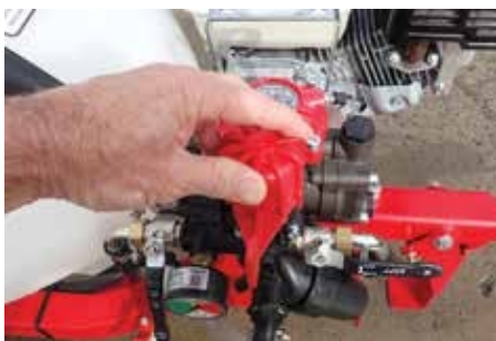
Figur 21: Juster trykket efter behov.
