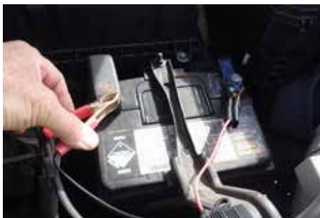
Figur 6: Alligatorclips – til tilslutning til dit 12-volts batteri
