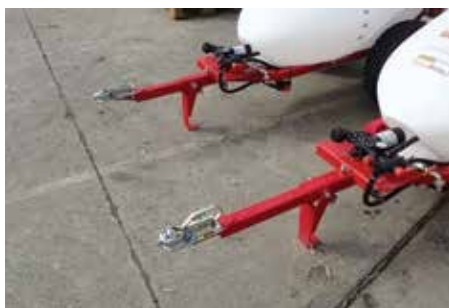
Figur 1: Trækstangsposition kort og lang
