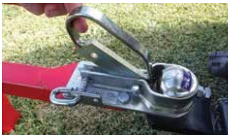
Figur 4a: Justering af låsearm.
