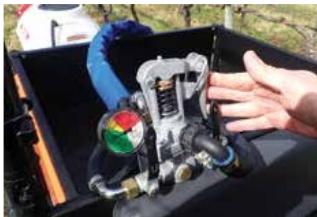
Figur 25: Den eksterne PRV (trykreguleringsenhed) skal monteres på det trækkende køretøj.
