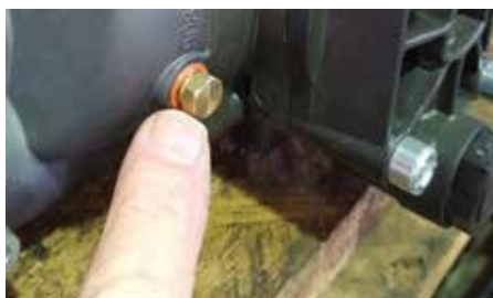
Figur 12: Kontroller gearkasseolie niveauet.
