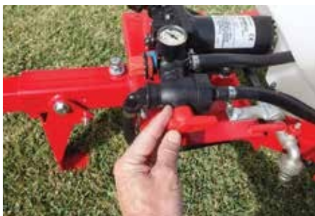
Figur 16: Kugleventil i slangetromleposition
