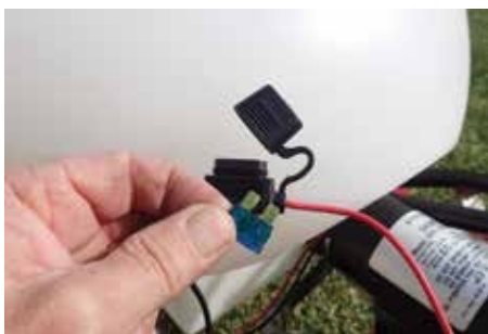
Figur 7: Sikring – integreret i ledningsnettet
